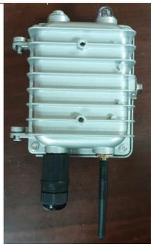
當巡檢員佩帶卡片接近 Locator 至感應距離時(直線 line of sight 約 30 米)，Locator 會感應與卡片的距離並將資料以 LoRa 訊號傳至中繼站(Gateway)，中繼站接收後再以無線訊號 NBIOT/4G 或有線方式傳回雲端主機，中繼站與 Locator 的傳輸距離在 500 公尺左右(空曠處可達 1000 公尺以上)，雲端主機收到資料後即可進行分析。卡片配有 SoS 按鈕，可提供呼叫服務，如選配 GPS 功能，卡片也會傳回 GPS 位置，確認其在廠區位置。
